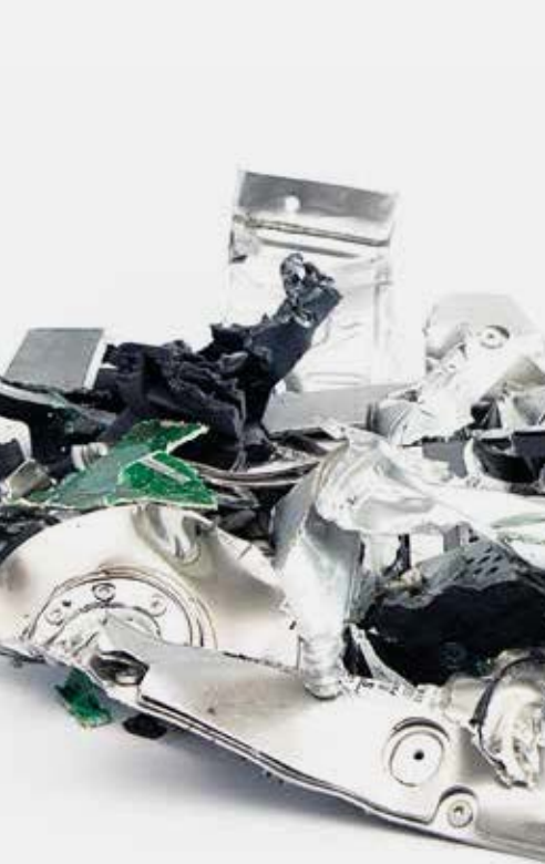
Hardeschijf vernietigd met de HSM StoreEx HDS 150 in veiligheidsniveau H-3.
