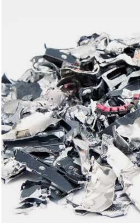
Hardeschijf vernietigd met de HSM StoreEx HDS 230 (eentraps) in veiligheidsniveau H-4.
