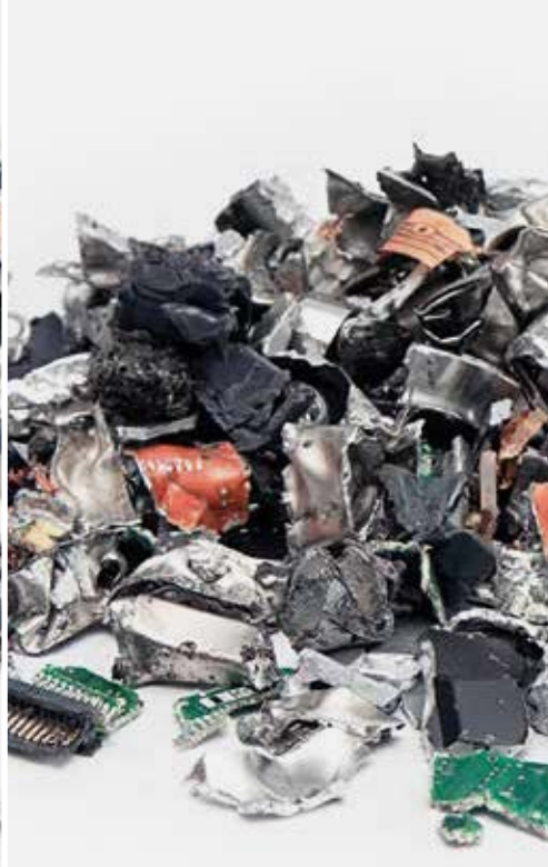
Hardeschijf vernietigd met de HSM StoreEx HDS 230 (tweetraps) in veiligheidsniveau H-5.
